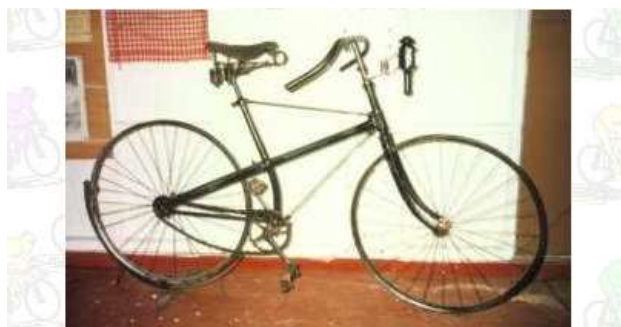
Bicyclette de 1888 à cadre en croix et transmission par chaîne
