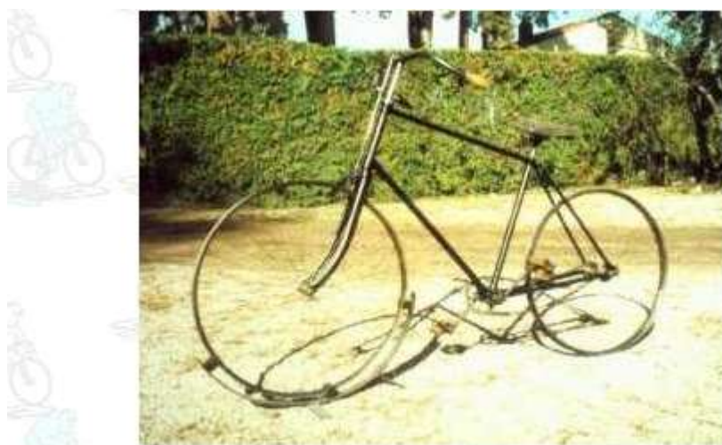
Bicyclette de 1890 à cadre classique et transmission par chaîne
