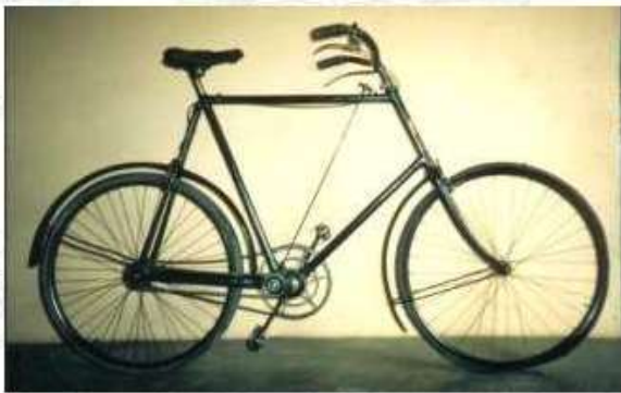
Vélo à deux chaînes, 3 vitesses dont 2 par rétropédalage
