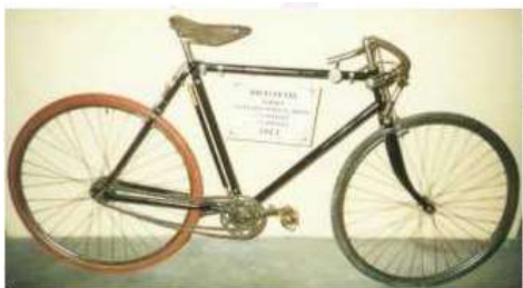
Vélo 6 vitesses = 3 dans le moyeu + 2 chaînes
