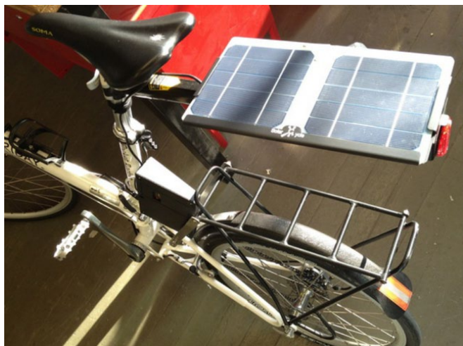
9. Solárna nabíjačka na dobíjanie elektronických prístrojov cez USB
