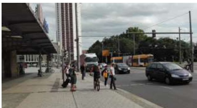
Riešenie pre cyklistov pred železničnou stanicou - chodci sú „posunutí“ za čiaru, aby ostal priestor na prejazd cyklistov
